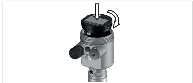
Fig. 10: Colocação do módulo de visualização e configuração na caixa de uma câmara no compartimento do sistema eletrônico
