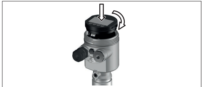
Fig. 10: Empleo del módulo de visualización y configuración en carcasa de una sola cámara el compartimiento de conexión
