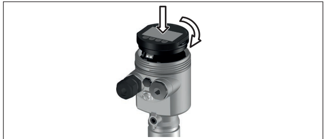
Fig. 10: Plaatsen van de display- en bedieningsmodule bij eenkamerbehuizing in elektronicaruumte.
