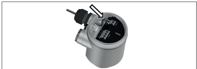
Figura 6: Operazioni di collegamento 5 e 6 - custodia a una camera
