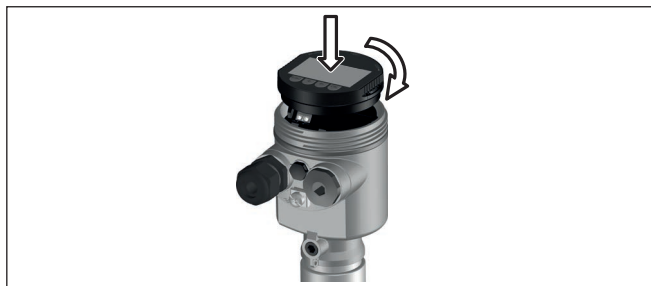
Figura 10: Inserimento del tastierino di taratura con display nel vano dell'elettronica in caso di custodia ad una camera
