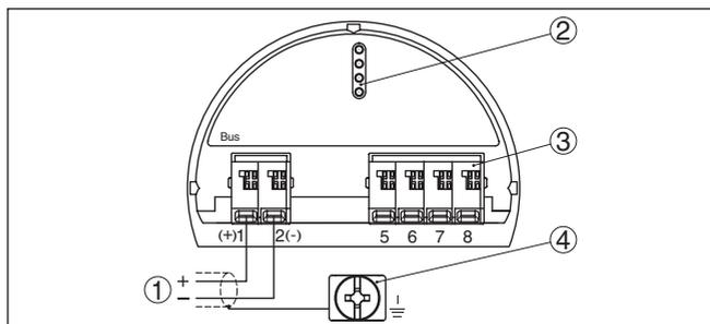
Figura 4: Vano di allacciamento - custodia a due camere
