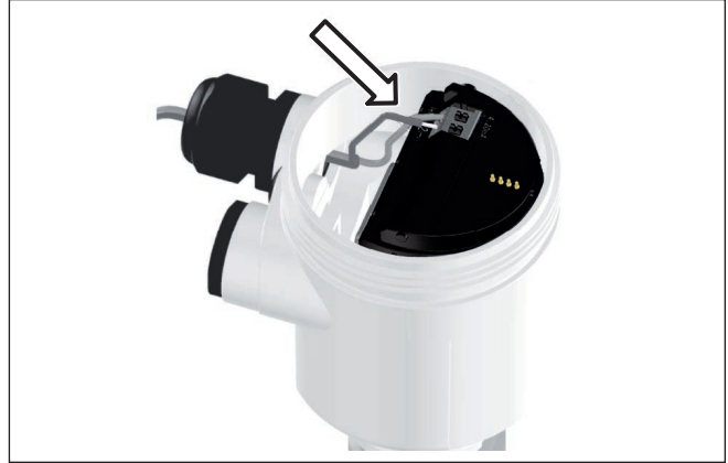
Res. 2: 5. ve 6. bağlantı adımları - Tek hücreli gövde
