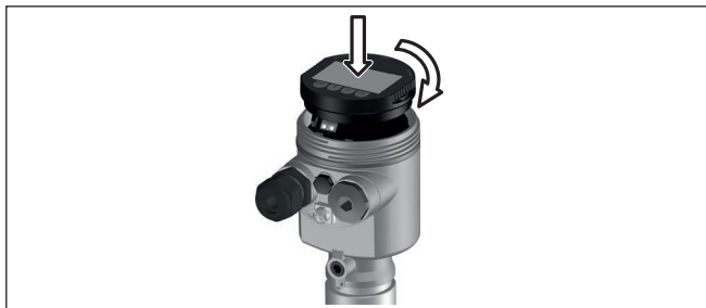
Fig. 31: Plaatsen van de display- en bedieningsmodule bij eenkamerbehuizing in elektronicaruiimte.
