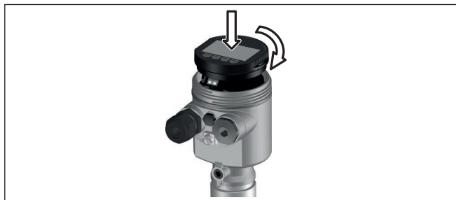
Fig. 31: Montage du module d'affichage et de réglage dans le boîtier à chambre unique se trouvant dans le compartiment de l'électronique
