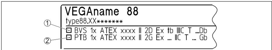
1 Identifizierungskennzeichen: Zündschutzart "Schutz durch Gehäuse Ex t"
