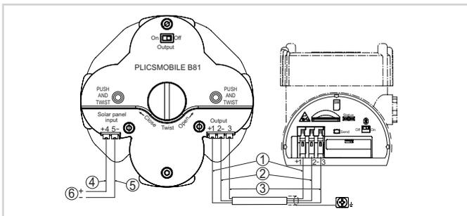
Anschluss der Batterie und des Solarpanels
