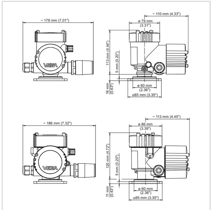
Dimensions PLICSMOBILE T81 avec boîtier en plastique et boîtier aluminium/acier inoxydable
