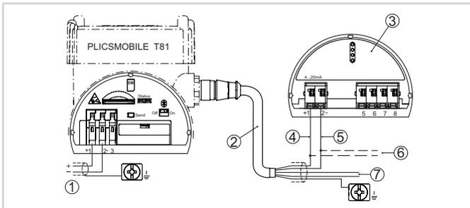
Raccordement de l'alimentation dans le boîtier de l'électronique
