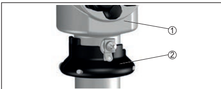
Abb. 26: Bloqueo de la carcasa para carcasa de acero inoxidable, electrolucidada
