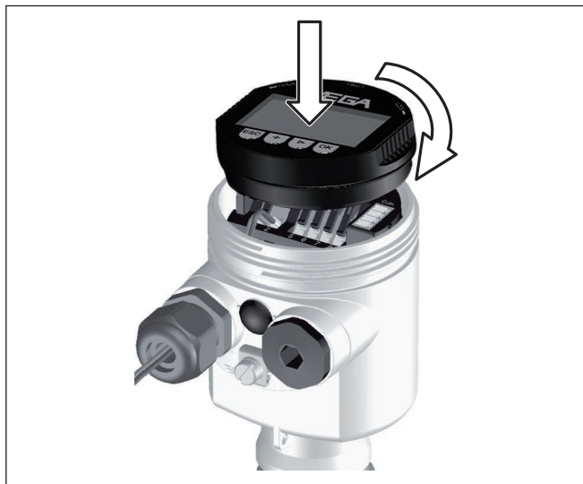
Fig. 6: Display- en bedieningsmodule in de eenkamerbehuizing plaatsen
