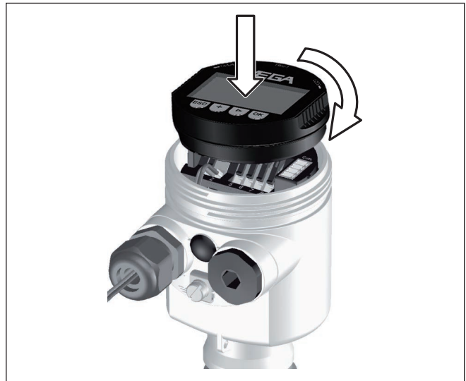
Fig. 5: Display- en bedieningsmodule in de eenkamerbehuizing plaatsen
