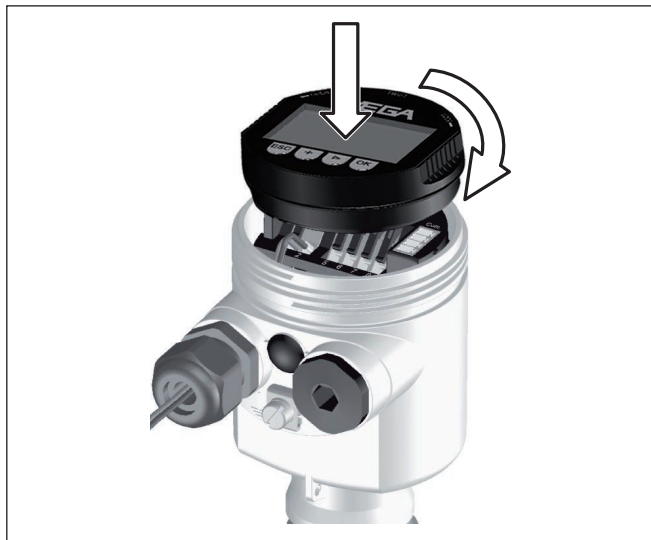
Figura 6: Inserimento del tastierino di taratura con display nella custodia a una camera
