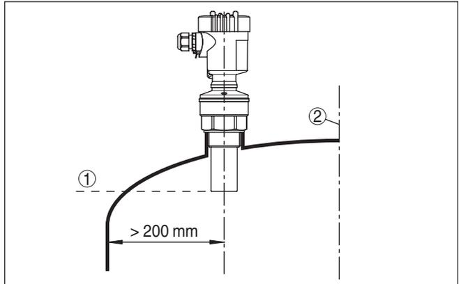
Fig. 2: Montage sur cuve à toit bombé
