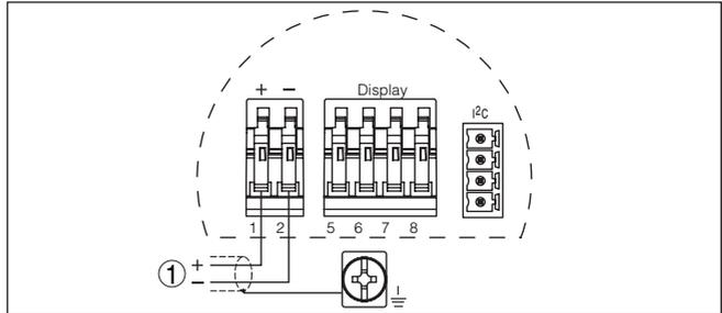
Fig. 4: Schéma de raccordement - boîtier à chambre unique
