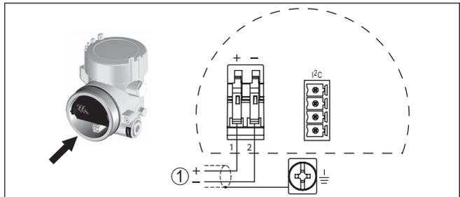
Fig. 5: Schéma de raccordement - boîtier à deux chambres
