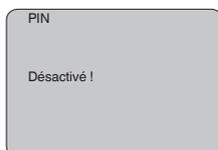
Le réglage du capteur via le module de réglage/affichage ou PAC-Tware/DTM au moyen de VEGACONNECT est ainsi de nouveau débloqué. Le PIN modifié reste valide pour l'accès (authentification) avec Bluetooth.
