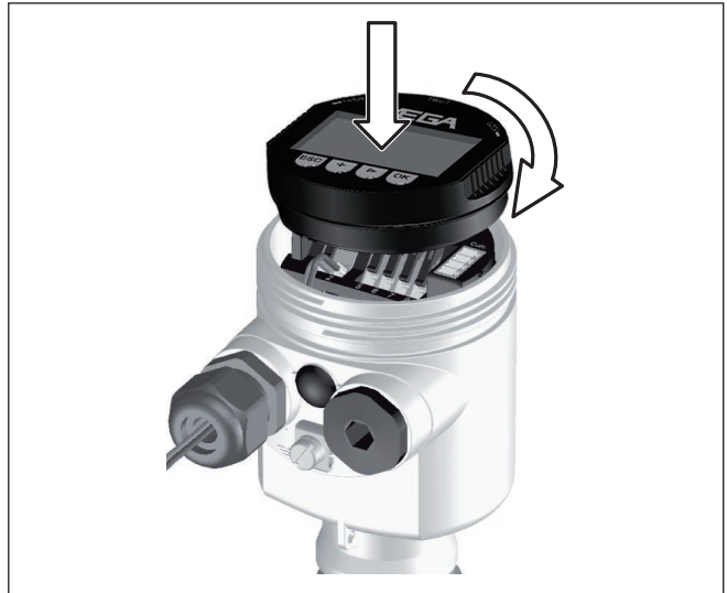
Abb. 6: Anzeige- und Bedienmodul im Einkammergehäuse einsetzen
