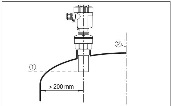
Fig. 2: Montagem em tampa redonda do reservatório
