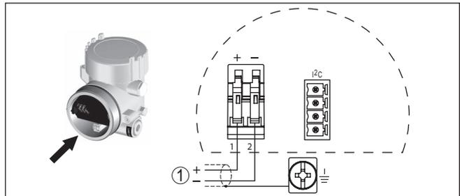
Fig. 5: Esquema de ligações - Caixa de duas câmaras
