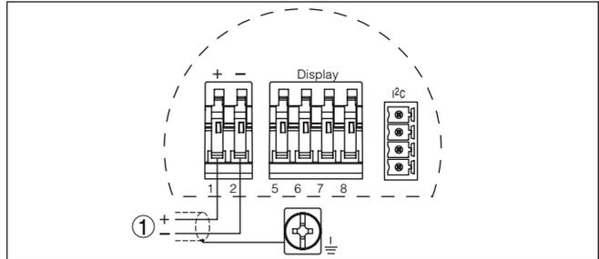
Fig. 4: Esquema de ligações - Caixa de uma câmara
