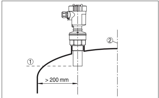
Fig. 2: Montaje en tapas de deposito redondas
