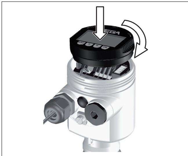
Fig. 5: Poner el módulo de visualización y configuración en la carcasa de una cámara
