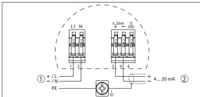
Fig. 4: Esquema de conexión - Carcasa de dos cámaras
