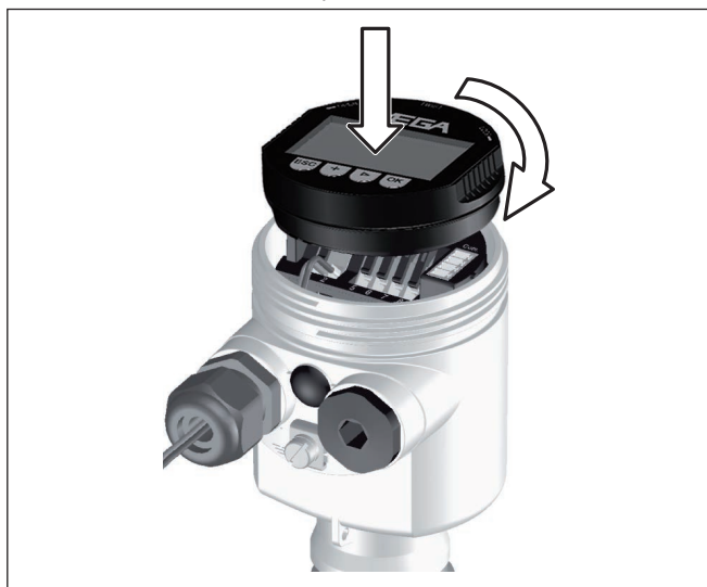
Fig. 5: Insérer le module de réglage et d'affichage dans le boîtier à une chambre
