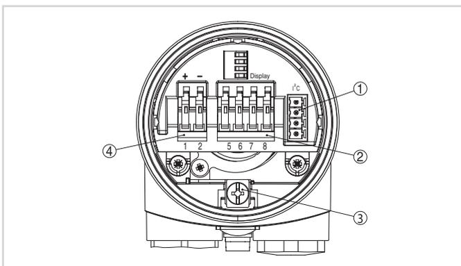
Compartiment électronique et de raccordement de boîtier à chambre unique
