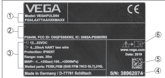
Fig. 1: Opbouw van de typeplaat (voorbeeld)
