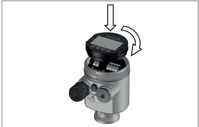
Fig. 10: Plaatsen van de display- en bedieningsmodule bij eenkamerbehuizing in elektronicaruiimte.
