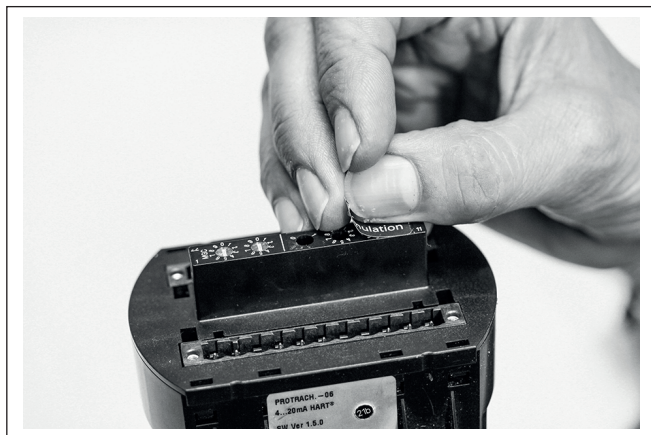
Rys. 2: Magistrala Profibus PA - ściągnąć folię ochronną znajdującą się nad przełącznikami do wybierania adresu
