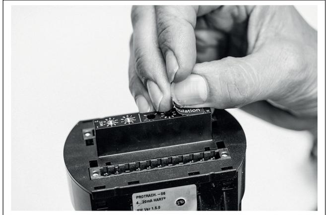
Fig. 2: Profibus PA - Abdeckfolie über den Adresswahlschaltern abziehen
