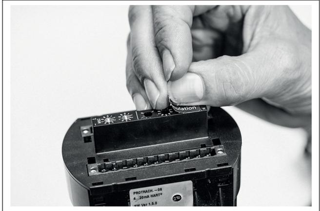
Fig. 2: Retirar la película protectora sobre los selectores de dirección
