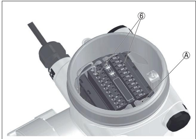
Fig. 6: Módulo electrónico en la carcasa
