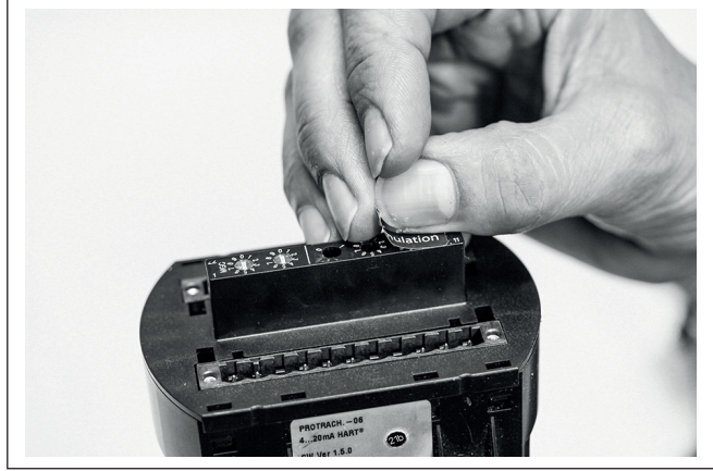
Res. 2: Profibus PA - Adres komut anahtarları üzerindeki koruyucu folyoyu çıkarmak
