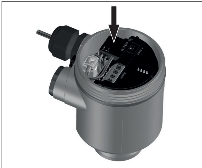
Fig. 2: Encaixar a proteção contra sobretensão no sistema eletrônico do sensor - caixa de uma câmara
