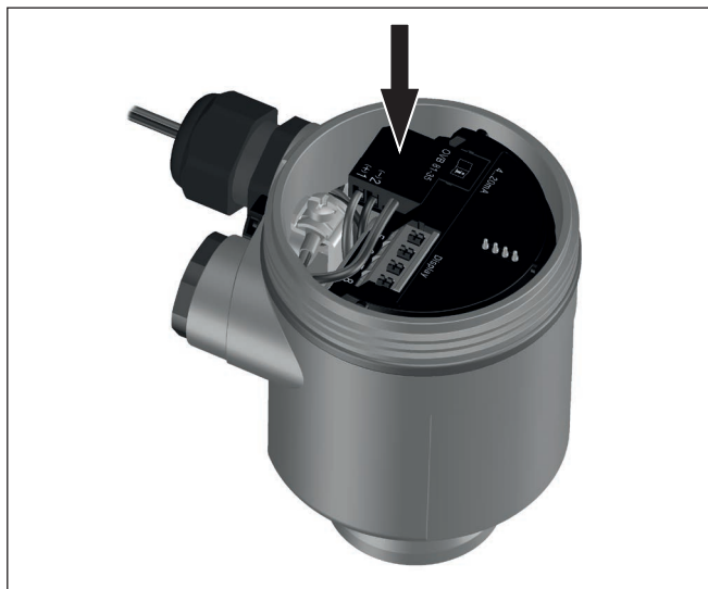
Fig. 2: Enficher l'appareil de protection contre les surtensions sur l'électronique du capteur - Boîtier à une chambre
