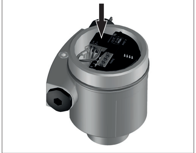
Res. 3: Aşırı gerilim güvenliğinin sensör elektroniğine takılması - Alüminyum tek hücreli gövde
