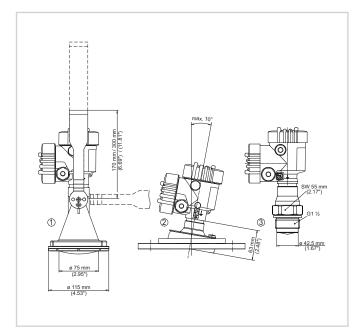
VEGAPULS 69, antenne à lentille à monture métallique en version à bride
