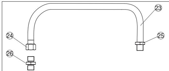
Abb. 9: Vorkonfektionierter Kühlmittelschlauch
