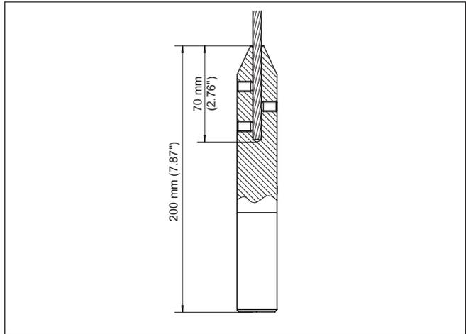
Fig. 23: Considerar el peso tensor, acortando el cable de forma correspondiente
