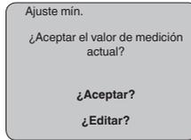
2. Aceptar el valor de medición actual o cambiar con "editar" a la ventana de edición Para editar colocar el cursor en la posición deseada con **[->]**. Ajustar el valor porcentual deseado con **[+]**, guardándolo con **[OK]**. Ahora el cursor salta al valor de capacidad.
