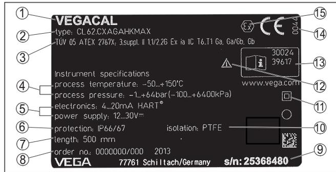
Fig. 2: Estructura de la placa de tipos (ejemplo)
