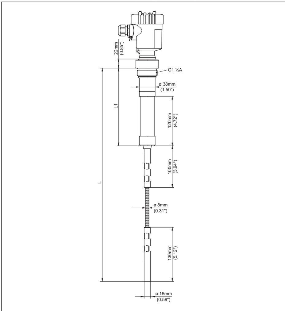
Fig. 31: VEGACAL 67, sonda de cable con aislamiento cerámico y manguito de compresión / -50 ... +350 °C <sup>5)</sup>
