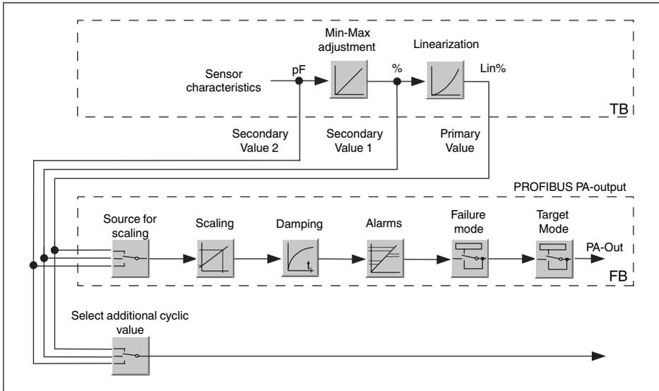
Fig. 25: VEGACAL 67: Diagrama de conexión con valor AI (PA-OUT) y valor cíclico adicional
