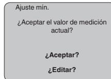
4. Aceptar el valor de medición actual o cambiar con "editar" a la ventana de edición. Para editar colocar el cursor en la posición deseada con **[->]**. Ajustar el valor porcentual deseado con **[+]**, guardándolo con **[OK]**. Ahora el cursor salta al valor de capacidad.
