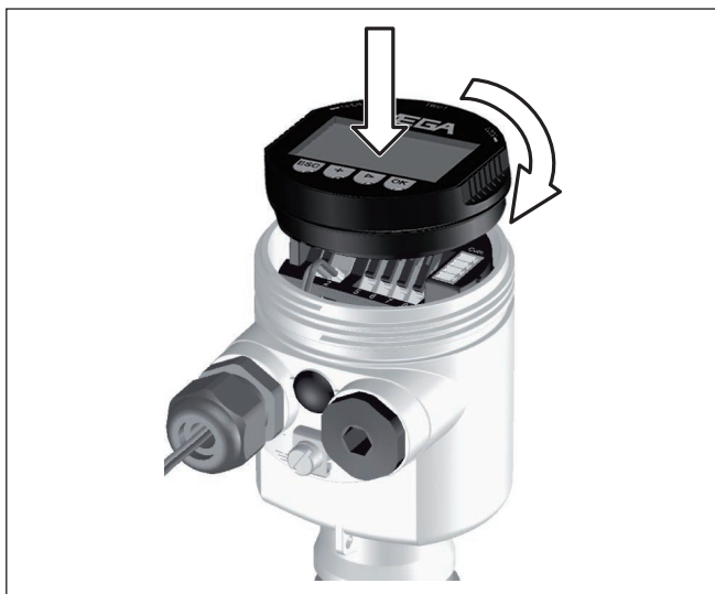
Fig. 16: Insérer le module de réglage et d'affichage dans le boîtier à une chambre
