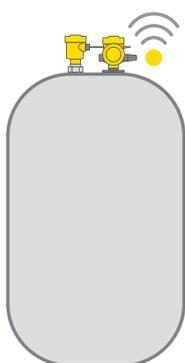
Os instrumentos para comunicação sem fio são utilizados quando os valores medidos precisam ser transmitidos de pontos de medição distantes ou de tanques móveis à centrais de registro de dados. Eles permitem também um diagnóstico e uma manutenção à distância dos sensores conectados.
