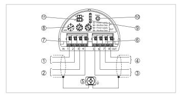
Compartimento de la electrónica - conexión Daisy-Chain
