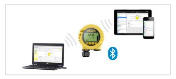
Conexión inalámbrica con instrumentos de configuración estándar
