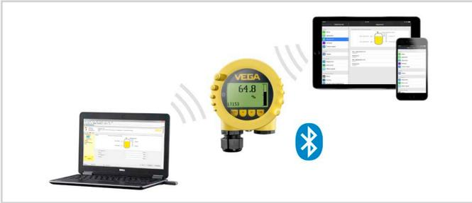
Collegamento wireless a strumenti di calibrazione standard
